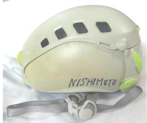
写真 1. 西本武志さんの Edelrid ヘルメット。 左右部と後部が内側に折りたためる。
